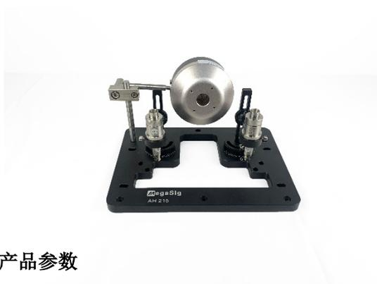
AH 215 专门为入耳式耳机音频测试所设计，并供刻度供参考，极高的测试重复精度。
